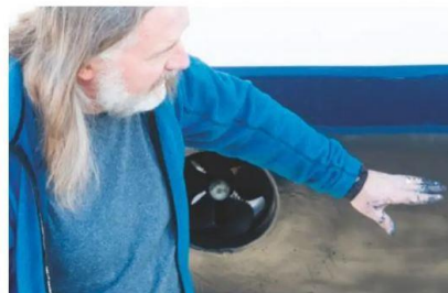
Johan Torstensson TBT-sanerade sin båt i fjol. "Allting är borta, sedan får man börja med epoximalning och sedan lägger man på bottenfärg i slutändan".
